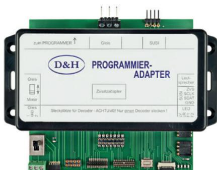
Der Programmier-Adapter ermöglicht die einfache Verbindung unserer Decoder mit dem Programmier. Unsere Sounddecoder mit 21-poliger, Next18- oder PluX-Schnittstelle können somit ohne Umstecken sowohl mit neuen Soundprojekten versehen als auch aktualisiert oder programmiert werden. Ein eingebauter Lautsprecher ermöglicht das direkte Ausprobieren des Sounds. Der Programmier-Adapter wird direkt an den Programmier angesteckt und benötigt daher keine eigene Verkabelung.
