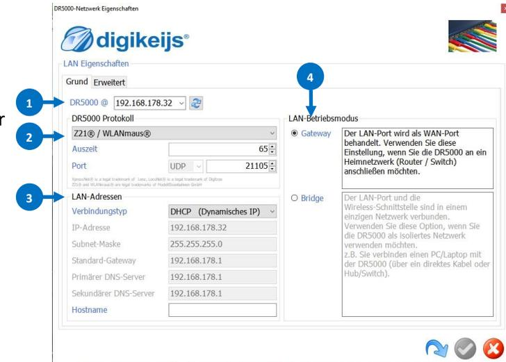
Wird die DR5000 **nicht** über die Lan Schnittstelle mit dem **Heimnetzwerk** (Router) oder über **Wlan** mit dem **PC, Laptop** verbunden, sind die Lan Einstellungen der DR5000 ausgegraut und **nicht zugänglich** und können deshalb **nicht verändert** werden! Eine Verbindung über **USB** zur DR5000 **wird immer** benötigt um die Lan Einstellung ändern zu können! **Bitte unbedingt beachten!**
