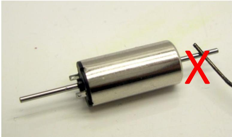
Tragen Sie keinen Kleber auf die Motorwellen auf. Das kann zum Verkleben der Lager führen.
